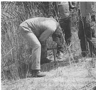
22. Kerja Gerudian Lubang Cetek dengan menggunakan Auger Tangan 'Guts'.
